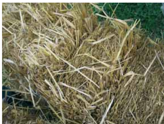
Een baal bestaat uit samengeperste stropakketjes van ongeveer 10 cm. Foto GRAT
