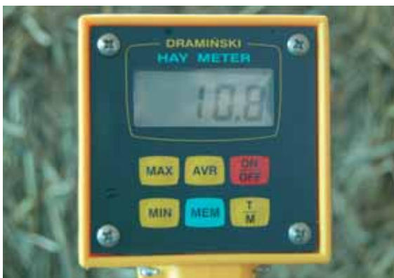
Meer dan 20% vocht maakt een baal ongeschikt. Hier geen probleem. Foto Casa calida vzw
